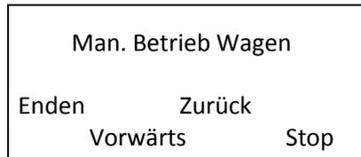
Mit Druck auf 'Enden' wird zurück zu dem vorhergehenden Untermenü gekehrt. Mit Druck auf 'Vorwärts' fährt der Wagen mit niedriger Geschwindigkeit vorwärts bis die 'Stop' Taste gedrückt wird oder die Heimposition erreicht wird. Mit Druck auf 'Zurück' fährt der Wagen mit niedriger Geschwindigkeit zurück bis die 'Stop' Taste gedrückt wird oder die Heimposition erreicht wird. Bitte beachten: Alle Weichen sollen manuell in Ausgangsposition gestellt werden.
